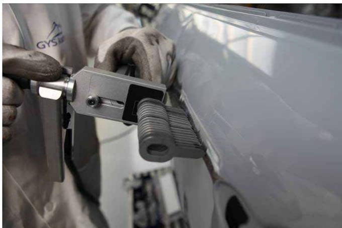
Si connette a tutti i dispositivi tira-bolli che hanno un sistema automatico di detenzione grazie alla semplice connessione della pinza di contatto Manuliner.
